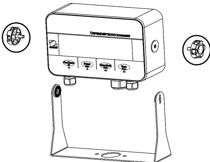
2. Retirez les six boulons à tête hexagonale du boîtier arrière de l'indicateur.
