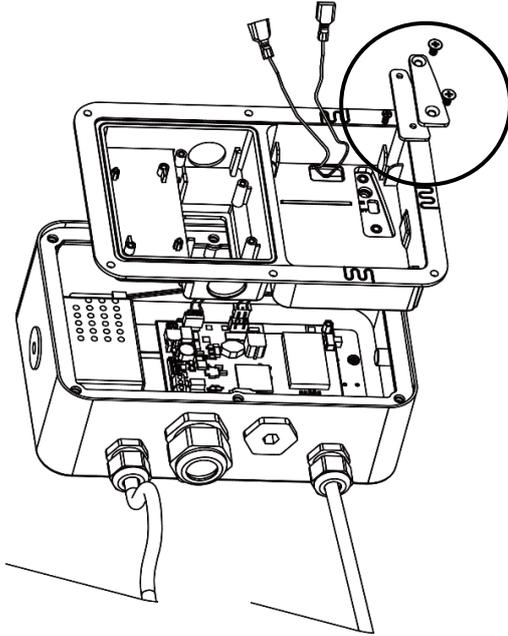
3. Relâchez le connecteur du capteur (entouré) en bas de l'indicateur, puis passez le câble du capteur à travers.
