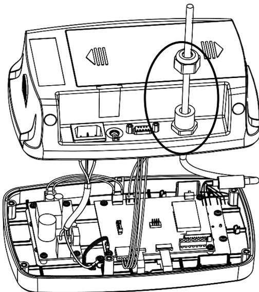
2. Raccordez tous les fils du câble de capteur au bornier du capteur sur la carte mère (entourée). Reportez-vous à la section **Bornier du capteur** pour plus d'informations sur les connexions.
