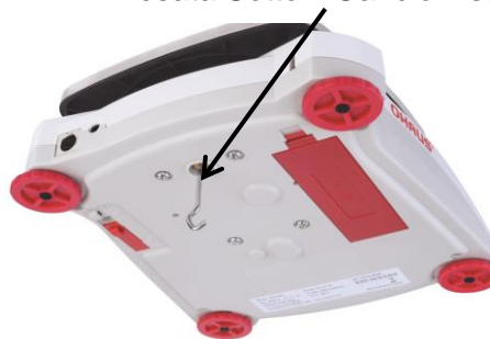
Pesata Sotto il Gancio installato
